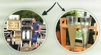
Auf den verschiedenen Stationen der Kläranlage werden teils automatisch, teils händisch über den Tag verteilt, Proben entnommen und im hauseigenen Labor untersucht. Die Messergebnisse sind für die Anlagensteuerung notwendig und werden auch gegenüber der Behörde dokumentiert. Zusätzlich gehen Proben an ein akkreditiertes Prüflabor, welches die Einhaltung der vorgeschriebenen Grenzwerte und die Reinigungsleistung der Kläranlage überwacht.
